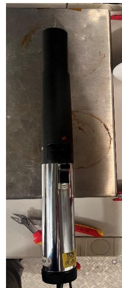
2 Hochspannungserzeuger mit Corona Aufladungsspitze
